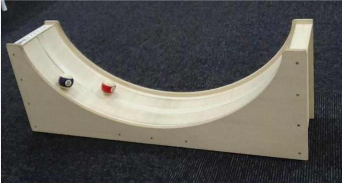
Si se coloca una pelota en cualquier punto excepto en el más bajo de la curva cicloide, la misma rodará de arriba hacia abajo repetitivamente. La pelota se detendrá únicamente cuando pierda energía, parándose así en el punto más bajo de la curva. El ciclo de tiempo requerido para que la pelota de un viaje de ida y vuelta es constante e independiente de la amplitud desde donde esta se suelte. Esta característica de la curva cicloide se llama **tautócrona**.
