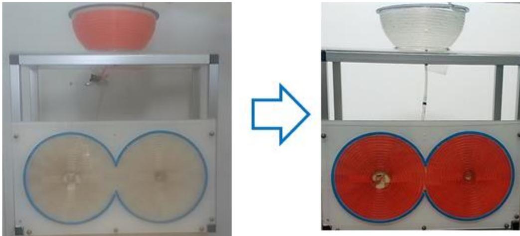
Este dispositivo demuestra el área de la superficie de una esfera. Consiste en tres tubos de manguera transparente formados en un hemisferio y dos círculos congruentes, y un líquido coloreado (rojo). Las tres figuras geométricas tienen los mismos radios, digamos  $r$ . Usando este dispositivo que se aproxima al área de la superficie, obtenemos:
