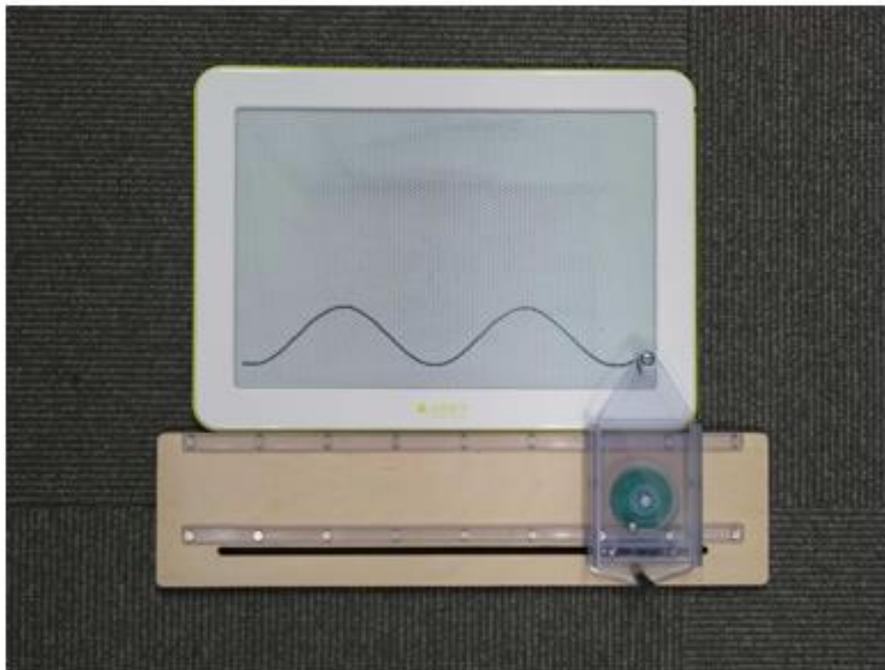
Consiste en un disco que puede ser rotado y una tabla deslizante que se mueve horizontalmente bajo el disco. El movimiento sincronizado del disco y la tabla produce curvas sinusoidales sobre el tablero.
