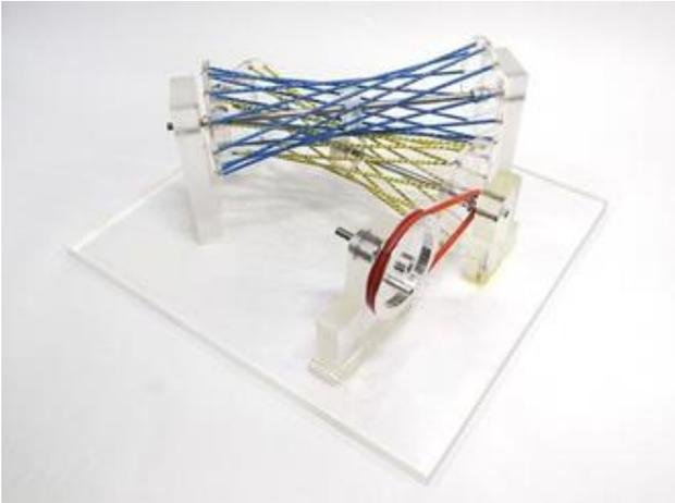
Este modelo ilustra cómo los mecanismos cambian la dirección del movimiento de un eje a otro. Aquí se muestran dos hiperboloides que son tangentes entre sí a lo largo de una línea. Cuando una de ellas rota sobre su eje, la otra es forzada a girar sobre su propio eje; esto crea un movimiento transformado en una dirección y otro movimiento en otra dirección.
