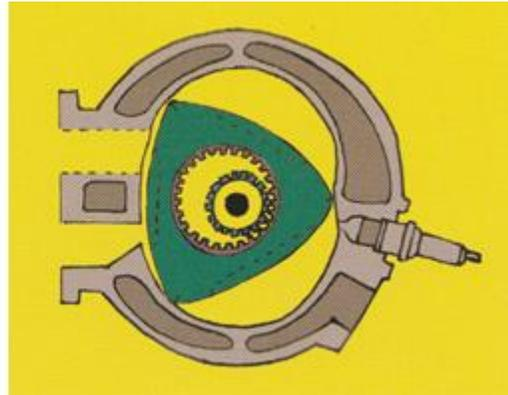
El motor tiene la forma de un triángulo de Reuleaux.
